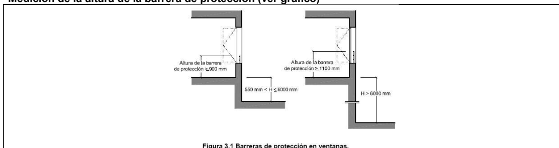
Figura 3.1 Barreras de protección en ventanas.
