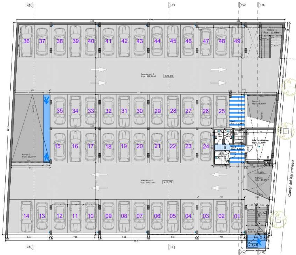
Modificació POUM 3.2: Proposta construcció aparcament. Planta soterrani
