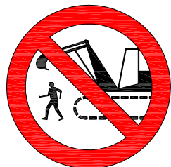
PROHIBIT TRANSITAR SOTA RADI D'ACCIÓ DE LA MÀQUINA
