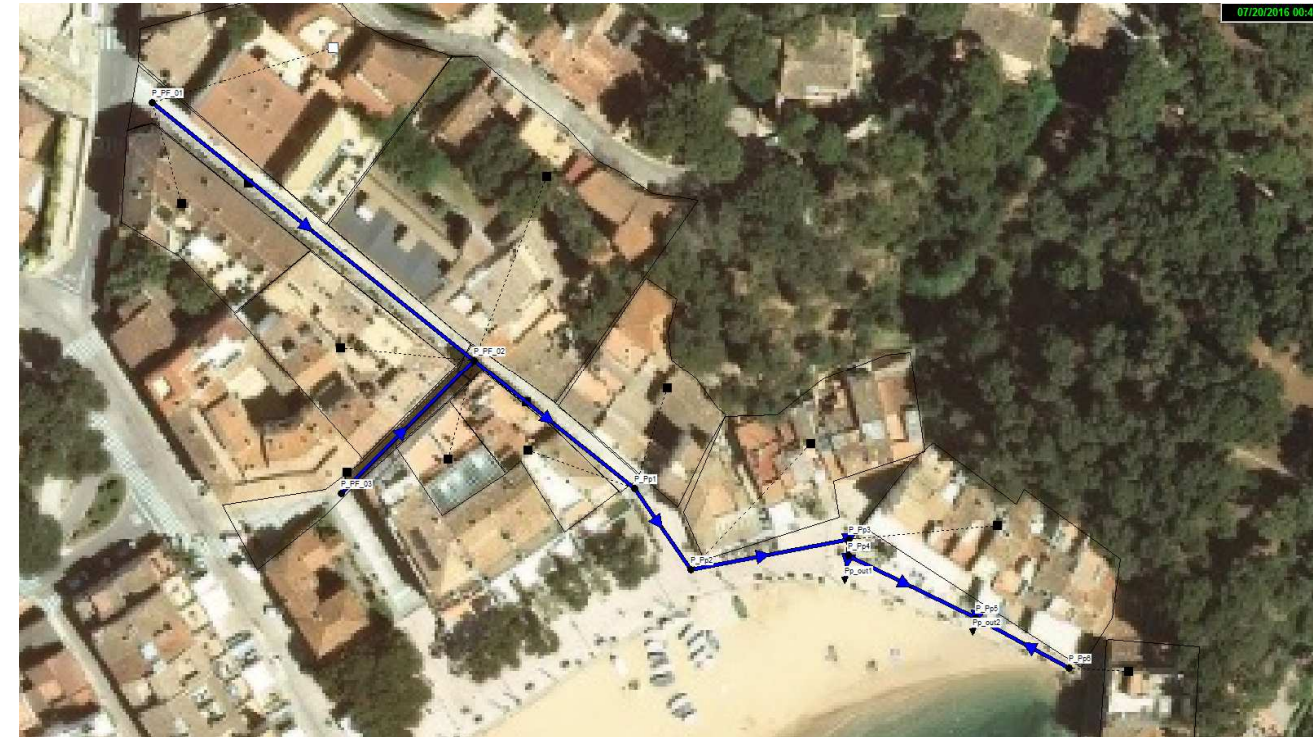
Imatge 4. Xarxa d'aigües plujanes proposada
