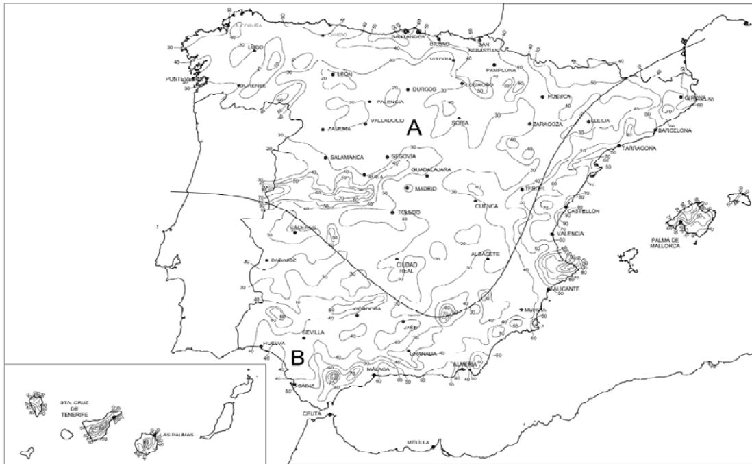
Intensitat Pluviomètrica i (mm/h)
