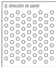
Ø 1.5 mm 23% Superficie perforada Δ 3 mm
