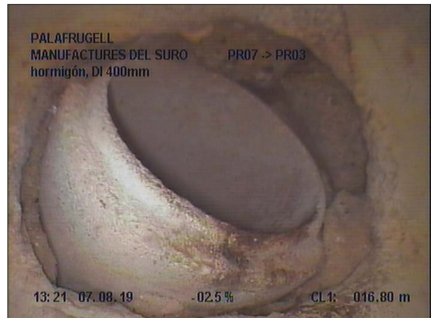
Fotografía: 56b, Nº Video: 139, 00:03:11 16,8m, Acometida desde 09 hasta 11 horas
