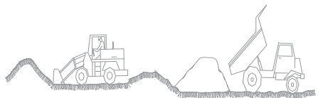
② DESMUNTS i TERRAPLENS AMB TERRES DE LA PROPIA EXCAVACIÓ O TERRES FORANIES
