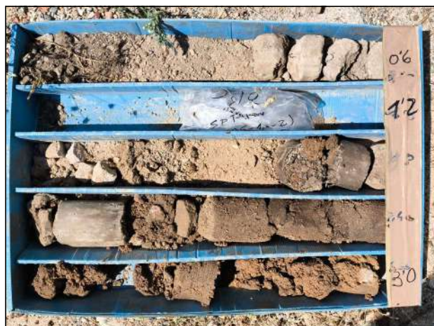
Fotografia 11: S-2. vista detalle nivel II, testigo a 8,80 m de profundidad.
